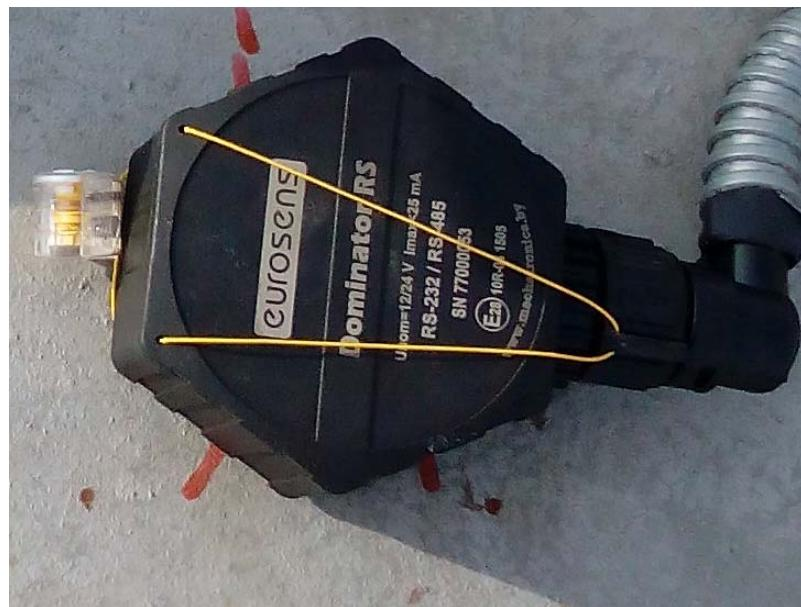
2. То же самое, что 1, но для пломбировки разъема используется отдельная пломба.
